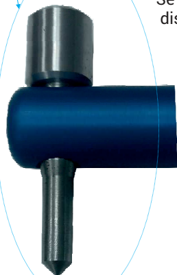
Foto de la barra patrón servida con el FIPSG100 de 250mm
