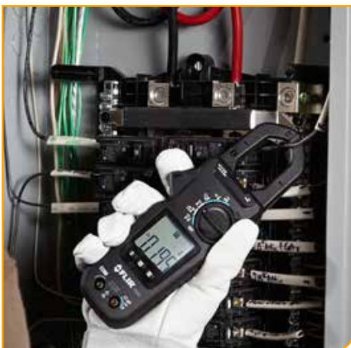
Accu-Tip permite mediciones de intensidad más precisas.
