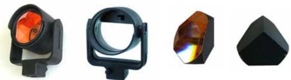
Figura 3 - Prisma circular consistente en una carcasa circular y un inserto de vidrio, visto desde diferentes perspectivas.
