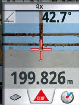
El puntero permite al usuario medir hacia objetos lejanos de forma rápida y sencilla, aún en condiciones de gran luminosidad. Aunque el punto láser no sea visible a simple vista, el objetivo aparece con nitidez en el gran display a color. La pantalla de alta resolución permite una imagen de nitidez insuperable. Gran precisión en las mediciones de grandes distancias.
