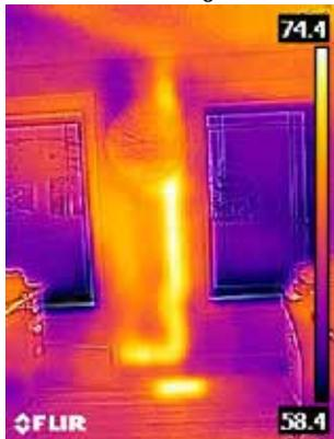
Tubo de drenaje caliente en la pared
