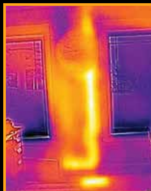
Tubo caliente en la pared
